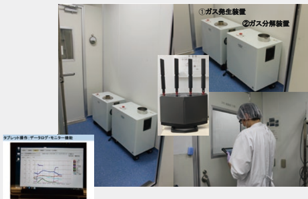
図5 パスルームの気相式除染システム (steriXcure)
