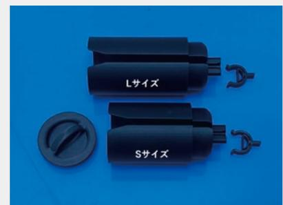
図4 マウスホルダおよび逸脱防止用キャップ
