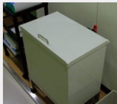
写真8：前室に設置された、着衣、防護衣など洗濯する前に消毒するためのシンク。
