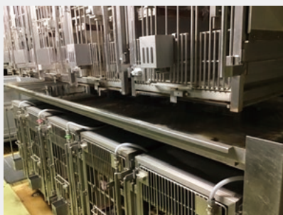
写真4：サルケージ下部のトレー、トレー内にスーパー次亜水が貯留する。
