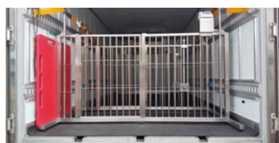
写真5. 柵と給水ボトル
