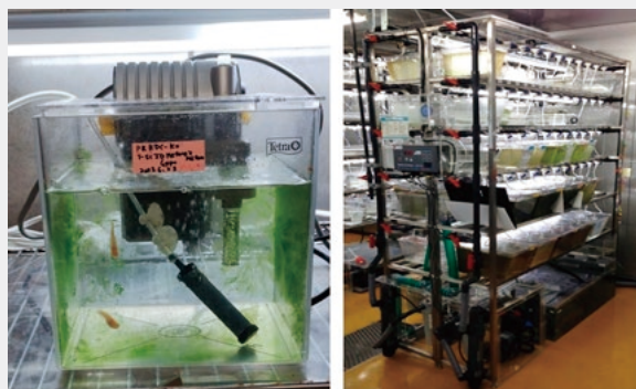
図2. メダカ飼育用小型水槽（A）と大型循環水槽（B）メダカは多様なスケールで飼育できる
