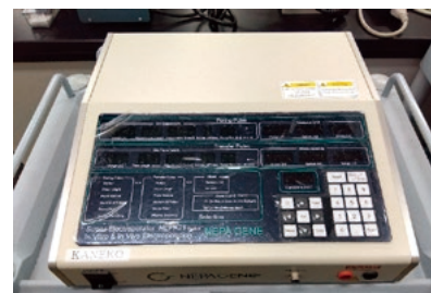
図1：テイク法に用いるエレクトロポレーター (NEPA21；ネッパジーン株式会社)
